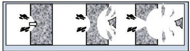
(a) 表面破壊/貫入 (b) 裏面剥離 (c) 貫通
