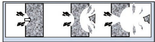
(a) 表面破壊/貫入 (b) 裏面剥離 (c) 貫通 図-12 コンクリート構造物の局部破壊 Fig. 12 Local failure of concrete structure
