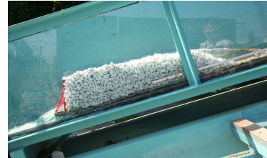
写真-3 礫捕捉状況 (側面)
