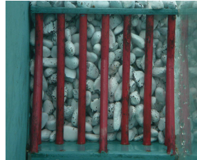
写真-2 礫捕捉状況 (正面)
