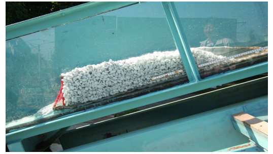
写真-4 実験 (粒径 1.0cm 以上)
