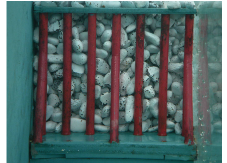
写真-3 実験による礫捕捉状況
