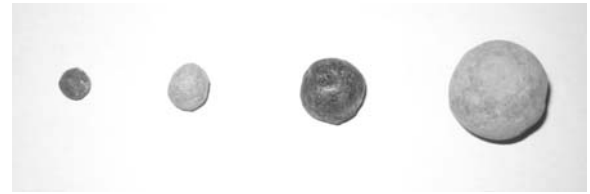
(a) 礫モデル (左から粒径 5, 10, 15, 30mm)
