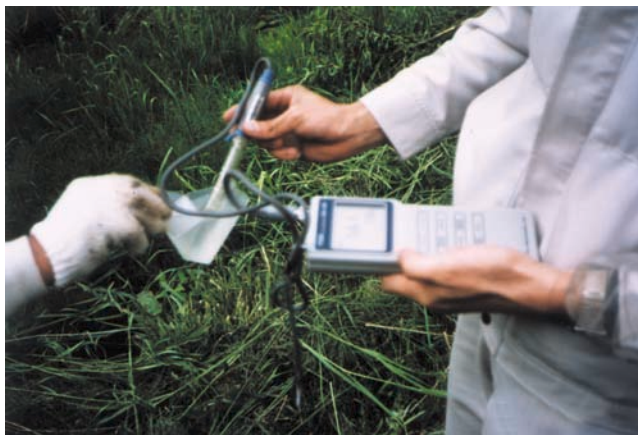
pH測定状況(水質の酸性度を調べる)
